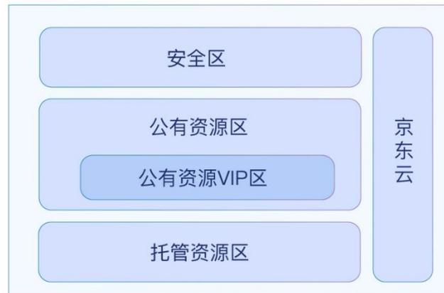
在此基础上，京东云对游戏行业还提供了一些特殊服务。对于公有云资源有着更严格安全和性能要求的游戏提供商，京东云在提供统一的安全入口基础上，在共有资源区中提供VIP区，VIP区中的虚拟资源对物理资源是独占的方式，而且在此基础上还可以对底层物理设备进行定制化配置，在利用公有云提供的控制面板、OpenAPI、CLI等工具的基础上最大程度的定制公有云环境。
