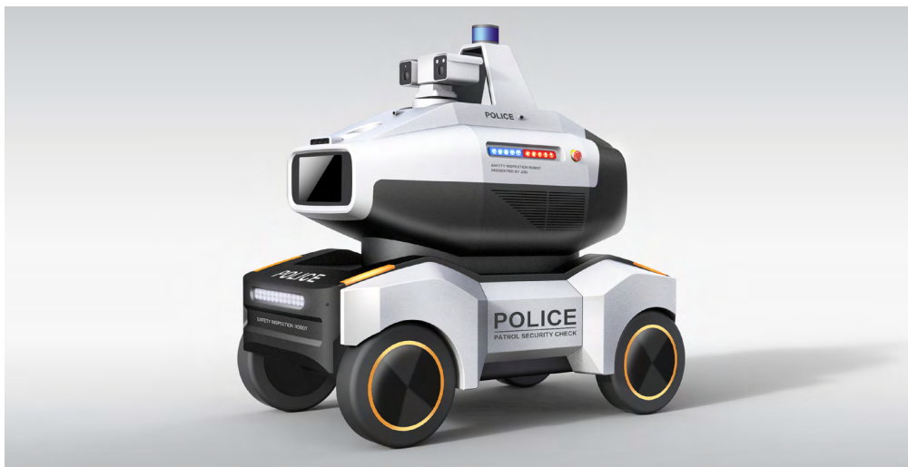
图 2.22 安防巡检机器人
