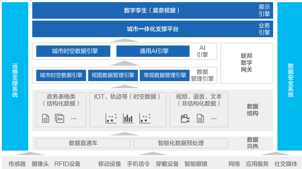
图 3.51 京东智能城市操作系统架构图
